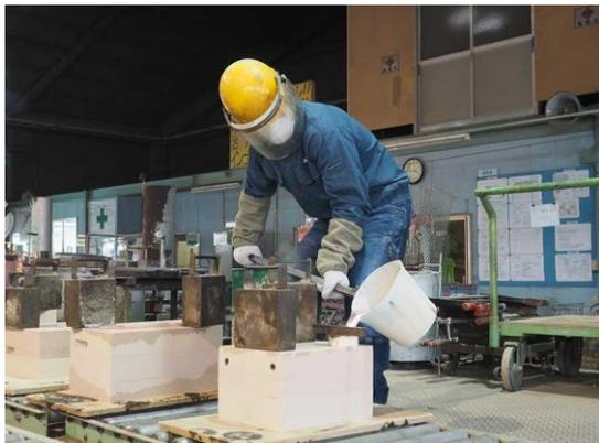
**鑄造（ちゅうぞう）**とは、主に鉄・アルミ合金・銅・真鍮などの金属材料を高温で溶解させ、砂などで作った鑄型（いがた）に流し込み冷やし固めることで目的の形状にする金属加工方法です。
